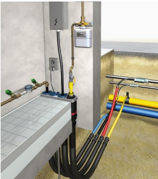
Beispiel Mehrsparten-Hausanschlusseinführung für nicht unterkellerte Gebäude
